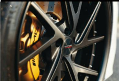
ホイールの回転方向に向かって倒れかかるとなる5×2本のスポークを持つのがHF-DiCの特徴。ハイパーフォージドとしては初の左右非対称パターンだ。ボルトホールとの関係にも一切無駄がなく、AMGダイナミックパッケージによる大型キャリパーを飲み込む。この個体、ディスクはアナダイズドブラックと微妙に質感を分けているのがポイント。コーディネート幅もハイパーフォージドの魅力だ。
