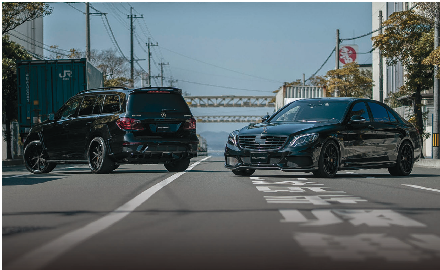
ブラバスのワイドスターキットでオーバーフェンダー化されたGL550。足まわりはiDのロウリングキットで調節し、またGL63AMG用ブラバス・バルブエキゾーストも備わる。
