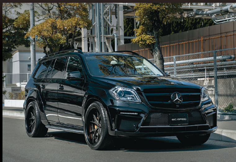
ブラバスのワイドスターキットでオーバーフェンダー化されたGL550。足まわりはiDのロウリングキットで調節し、またGL63AMG用ブラバス・バルブエキゾーストも備わる。
